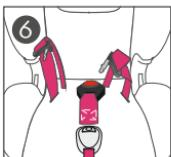
**Шаг 6:** Вытащив металлический фиксатор на конце ремня с пряжкой, отсоедините его от корпуса автокресла.
