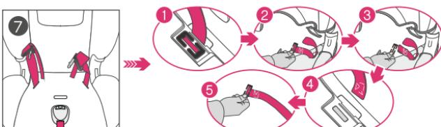
**Шаг 7:** При помощи инструмента отсоедините металлические фиксаторы на концах поясных ремней автокресла, разверните ремни из корпуса, установите металлические фиксаторы на концы ремней.
