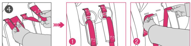
**Шаг 4:** Отсоедините плечевые накладки от ремней. Вытяните плечевые накладки из спинки автокресла, разверните их и выньте из них ремни безопасности.
