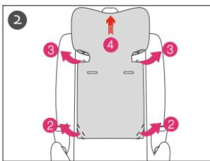
**Шаг 2:** Отсоедините края чехла от корпуса подголовника в местах 2, 3. Затем снимите его в направлении стрелки под цифрой 4.
