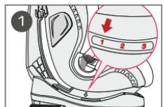
**Шаг 1:** Нажмите на педаль регулировки угла наклона спинки и установите спинку в положении 1.
